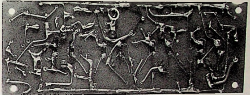
Achterzijde met doorgesoldeerde bedrading van de 2-meter zender.
